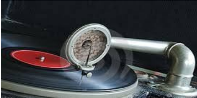
Disco in vinile a 78 giri/minuto e puntina con membrana
